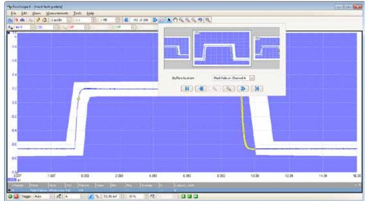
突出显示的详细信息一直在显示屏上显示，可使示波器在您处理其他事务时捕捉瞬时脉冲波形干扰。测量窗口计算故障数量，同时可显示其他测量与统计信息。您可以将容限作为文件导入和导出。
