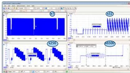
缓冲器以 1 GS/s 速率进行采样，直至 50 ms/div (500 ms 总共捕捉时间)。
