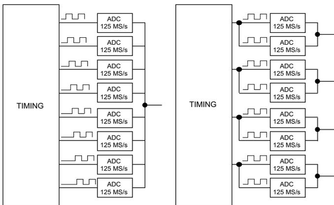
在并行模式，多个 ADC 在每条通道内进行同相采样，使每条通道 (70 dB SFDR) 内的分辨率在 125 MS/s 时提高至 14 位 (参看示意图)。如果仅需两条通道，分辨率能够提高至 15 位，在单通道模式，所有 ADC 相互结合，可在采样分辨率为 62.5MS/s 时提供 16 位模式。
