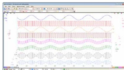
**PicoScope:** 显示屏既可以简单也可以复杂,一切按照您的需求而定。首先使用一个通道的单一视图,然后放大显示屏从而包括任何数量的实时通道、数学通道与参考波形。
